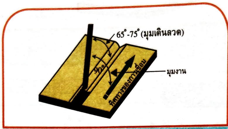
ภาพที่ 2.21 แสดงมุมและทิศทางของการเชื่อมต่อชนทำราบ
